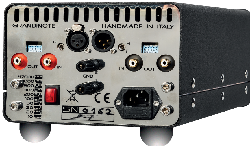
Die beiden Erdungsanschlüsse sind unterschiedlich – man nimmt den, bei dem's weniger brummt
